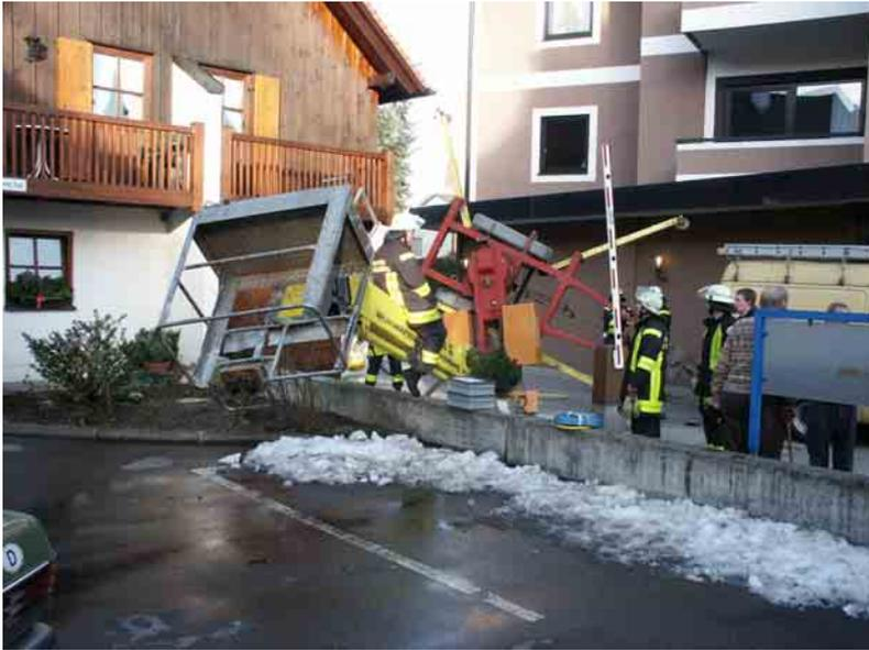
Bei Ausbesserungsarbeiten an einem Gebäude stürzte der Anhäng-Hubsteiger um. Dabei fiel eine Person aus dem Arbeitskorb und musste mit schwersten Verletzungen mit dem Rettungshubschrauber in eine Spezialklinik geflogen werden.
