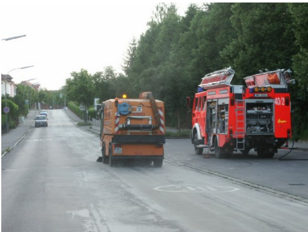
Aufnahme des Ölbindemittels mit einer Kehrmaschine
